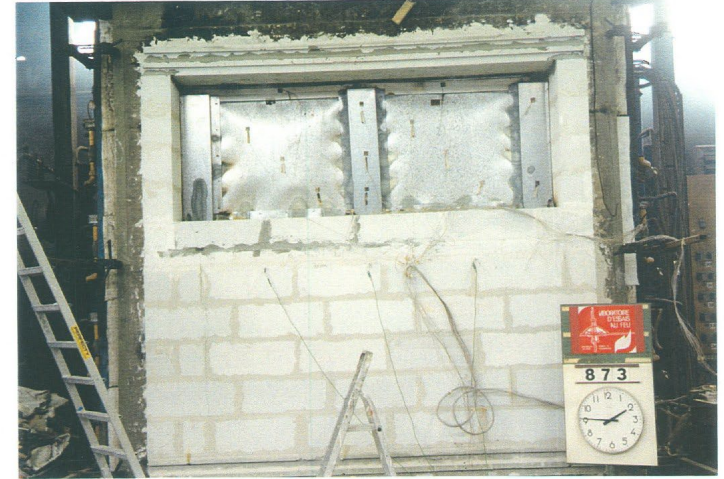
Face non exposée au temps 105 minutes
