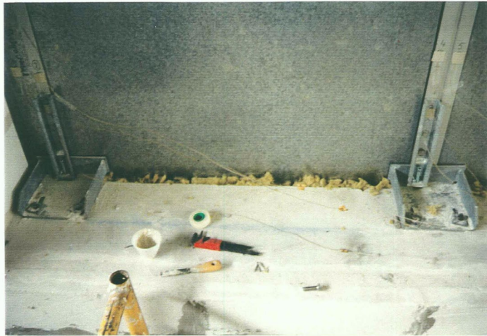
Position des thermocouples à l'intérieur de l'élément
