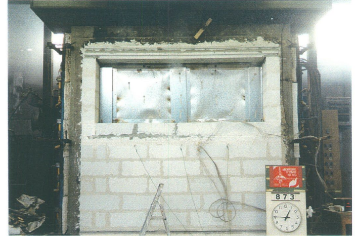
Face non exposée au temps 45 minutes
