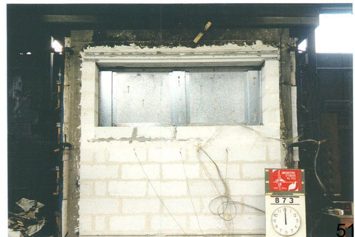
Vue de la face non exposée au temps 0 minutes
