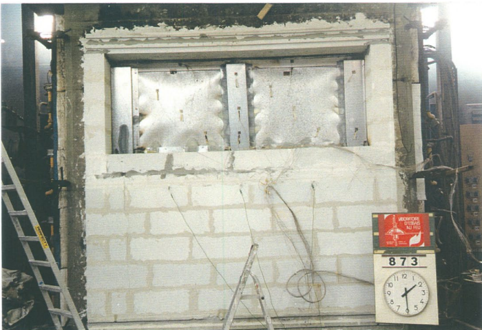
Face non exposée au temps 90 minutes
