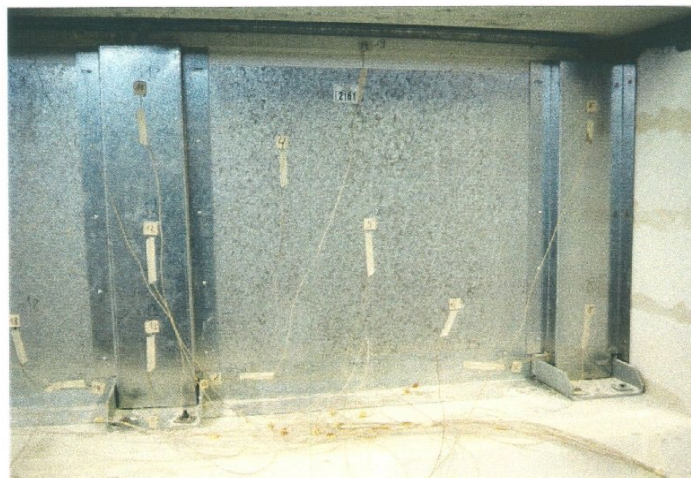
Vue de la face non exposée au feu
