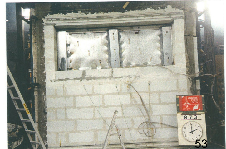
Face non exposée au temps 120 minutes
