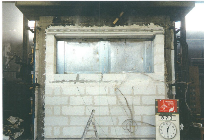
Face non exposée au temps 30 minutes
