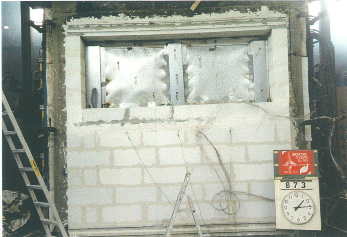
Face non exposée au temps 75 minutes
