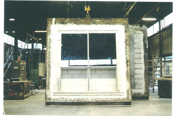
Vue de la face exposée au feu avant l'essai
