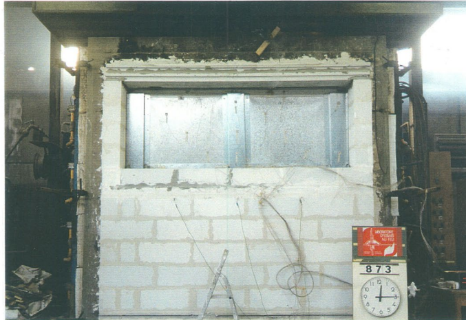
Face non exposée au temps 15 minutes
