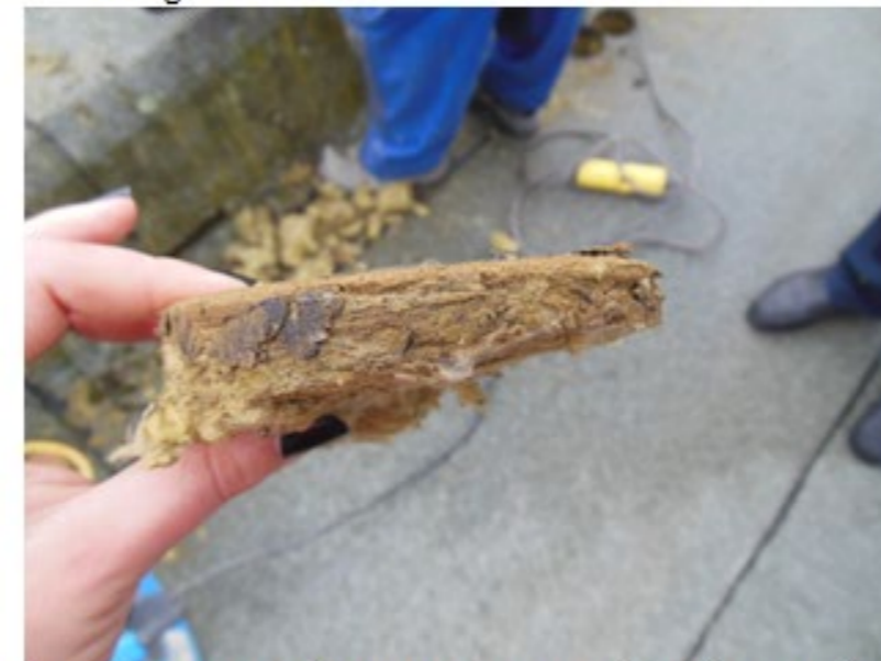
Foto 5: Boring 2 - bovenste 2cm minerale wol is meer dens
